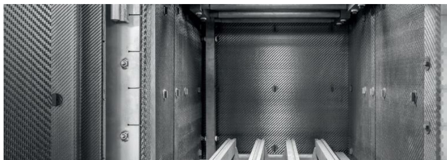
Защита теплоизоляции внутреннего пространства печи углерод-углеродным композиционным материалом
