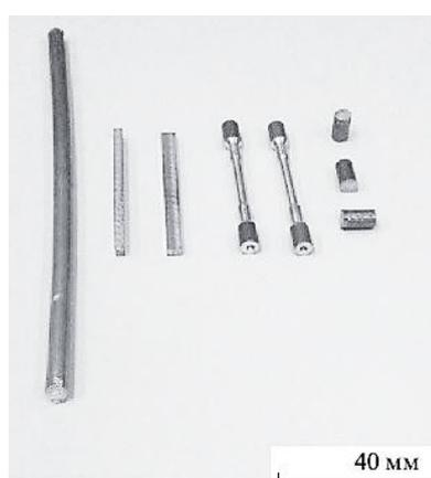
Исследовано влияние термической обработки на структуру, фазовый состав и механические свойства наноструктурных алюмоматричных композиционных материалов, модифицированных фуллереном  $C_{60}$ . Методом индентирования и одноосного сжатия в интервале температур от 25 до 350°C изучены прочность, твердость и модуль упругости исследуемых материалов. Установлена зона температурной стабильности структуры и фазового состава композитов и возможный температурный интервал эксплуатации изделий на их основе.
