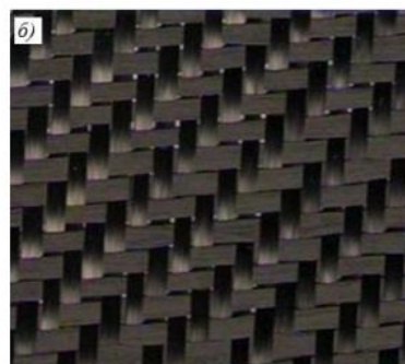
Рис. 3. Плиты из углепластиков на основе гибридного металлоуглеродного армирующего наполнителя марки ВТкУ-2.280М (а) и углеродного армирующего наполнителя марки ВТкУ-2.200 (б)
