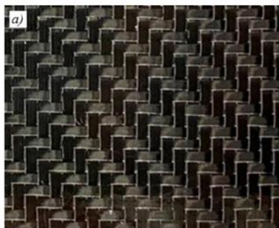
Рис. 3. Плиты из углепластиков на основе гибридного металлоуглеродного армирующего наполнителя марки ВТкУ-2.280М (а) и углеродного армирующего наполнителя марки ВТкУ-2.200 (б)
