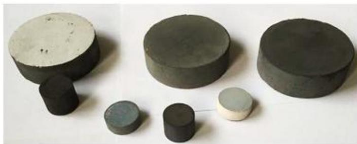
Получены образцы корунд-углеродной керамики с различным объемным содержанием искусственного графита (0-20%) и графена (0-4%) и исследована их удельная электропроводность. Показано, что с ростом объемного содержания проводящего компонента удельная электропроводность
