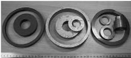
**Рис. 1.** Последовательность получения карбидкремниевой конструкционной керамики: карбидкремний-углеродные заготовки (слева); заготовки после силицирования (в середине); финишные изделия после механической обработки (справа).
