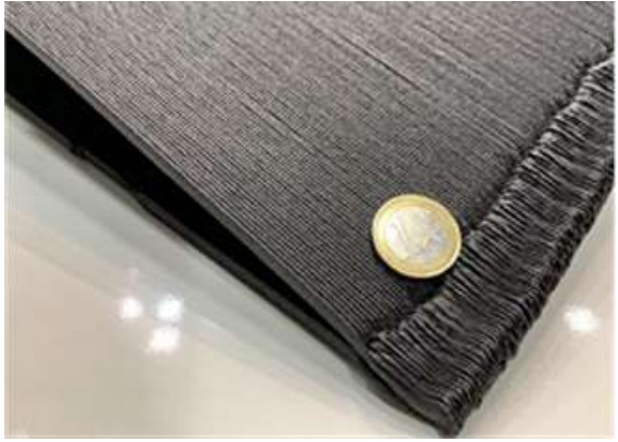
Поверхность детали из термопласта, упрочненного рубленым углеволокном, технология FDM, CEAD
