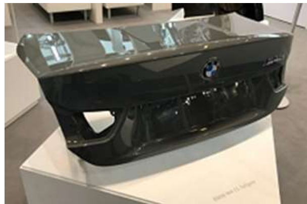
Багажник BMW M4: внешняя часть стеклонаполненный композит (SMC), внутренняя часть: угленаполненный композит (SMC)
