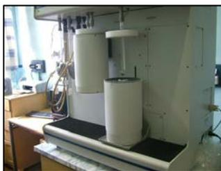
Автоматизированная система ASAP 2020 (Micromeritics, США)
