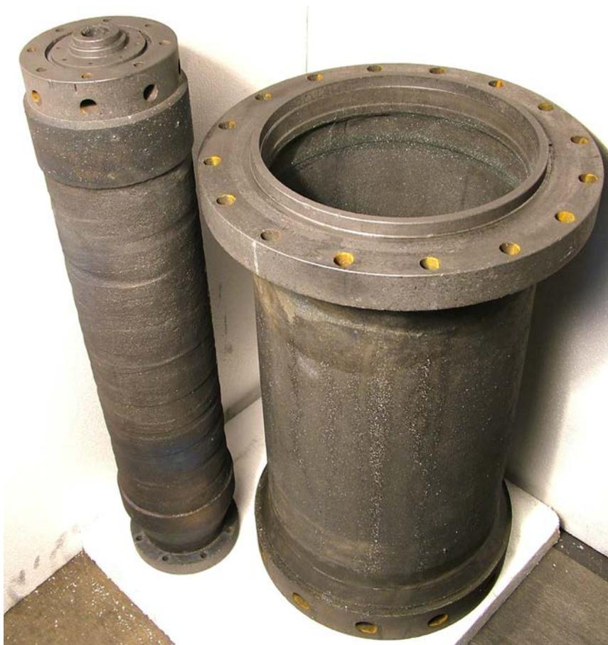
*Рисунок 9. Фрагменты химического реактора из углерод-керамического композита и силицированного графита. (Диаметр наибольшего фланца 400 мм.)*
