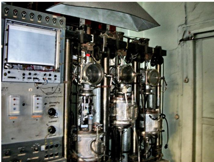
Высокотемпературная установка ИМГ 3000-1000 для испытаний образцов на растяжение, сжатие и изгиб в среде инертного газа и вакууме в диапазоне температур 20-3000°C
