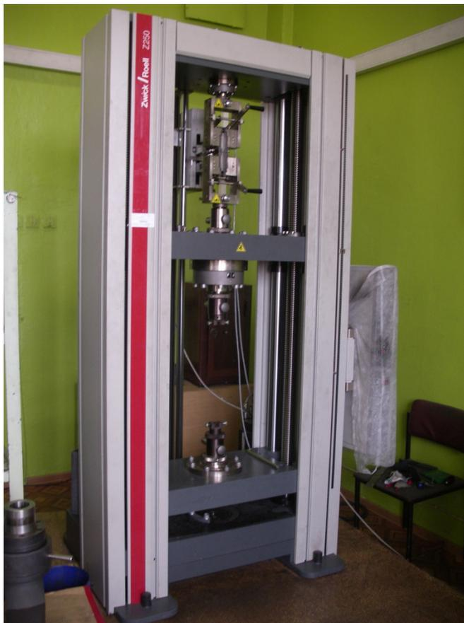
Универсальная испытательная машина Zwick/Roell Z250 для испытаний на растяжение, сжатие и изгиб.
