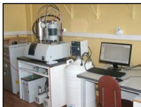
Прибор STA-449 F1 Jupiter (NETZSCH, Германия)
