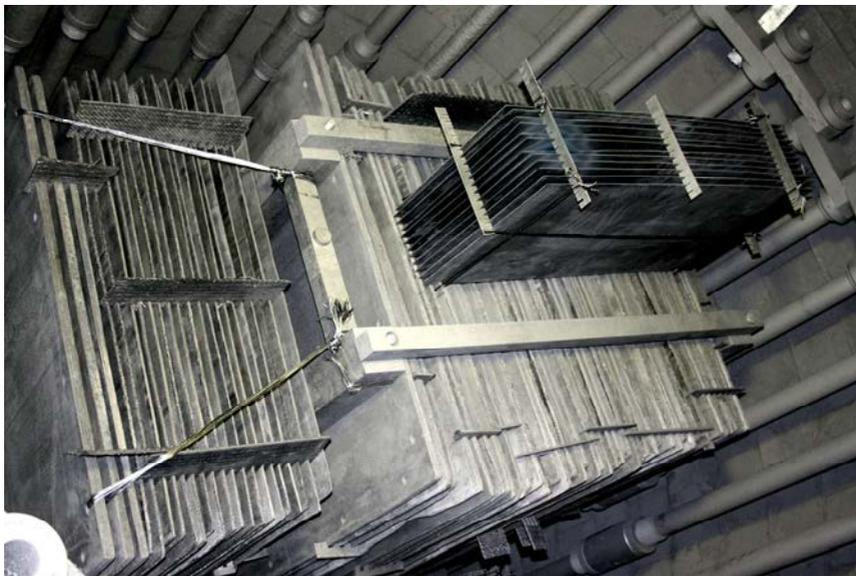
*Рисунок 5. Общий вид садки пластин из углерод-углеродного композита на основе углеродных тканей из вискозы в объеме электровакуумной печи. Общая масса садки ~ 1000 кг. Размеры до 2000 мм. Толщины от 4 до 12 мм. Садка показана после высокотемпературной технологической обработки при максимальной температуре ~ 1850 °С.*
