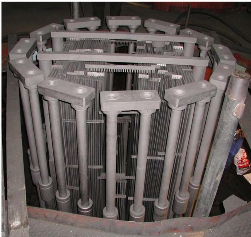
*Рисунок 8. Общий вид размещения пластин из двумерно армированного углеродного композита в электровакуумной печи на технологической операции осаждения пироуглеродной матрицы в поровом объеме углеродного каркаса.
