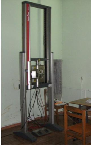
Универсальная испытательная машина Zwick/Roell Z010 для исследований и определения прочностных и деформационных характеристик углеродных нитей, тканей
