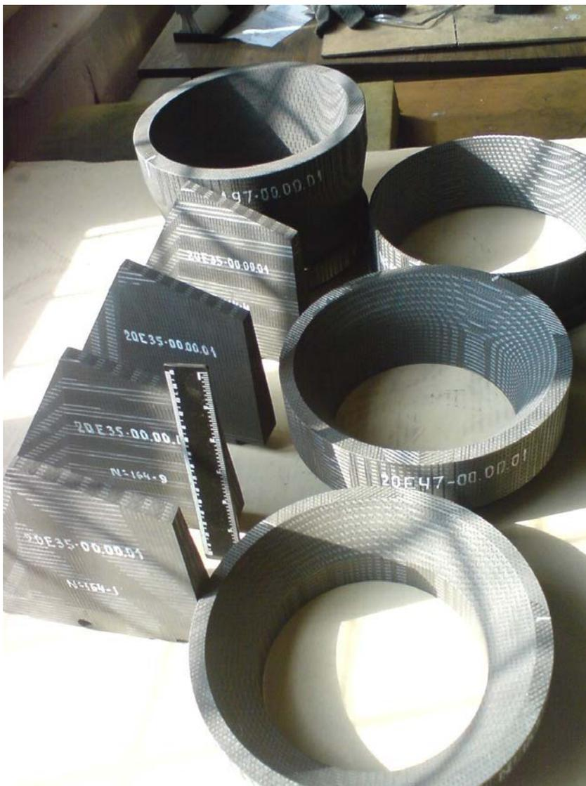
*Рисунок 6. Образцы продукции из четырехмерно армированного углеродного композита «Десна-4» (схема армирования 4DL), полученного на основе углеродной матрицы из каменноугольного пека*
