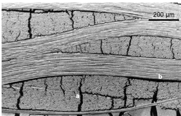
*Рисунок 4. Сканирующее электронное изображение C/C композита для силицирования [29]*
