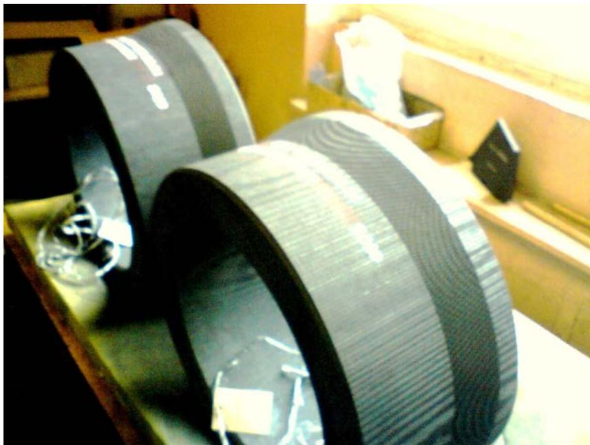
*Рисунок 3. Общий вид продукции из материала «Десна Т-1».
