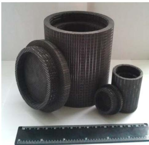
*Рисунок 1. Внешний облик и свойства материала КМ-ВМ-4Д\* (на основе стержневых каркасов структуры 4D-L) с различным коэффициентом теплопроводности*
