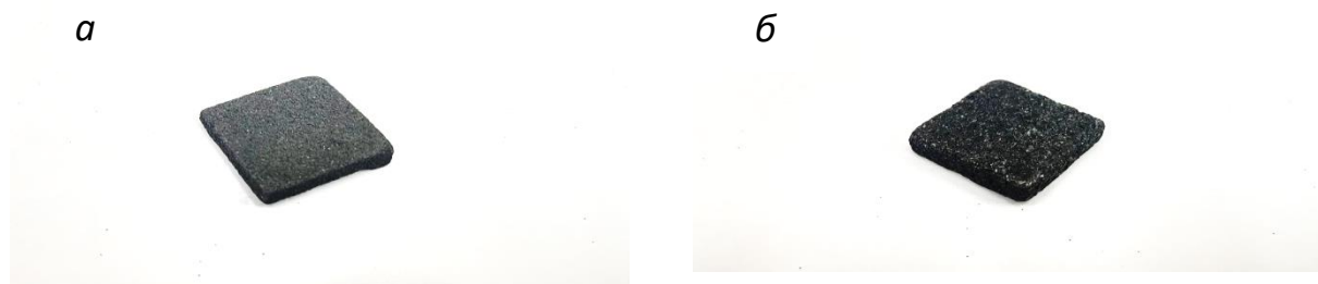
Рисунок 1 - Фотографии образцов графитов МПГ-6 и ЗОПГ после жидкофазного окисления
