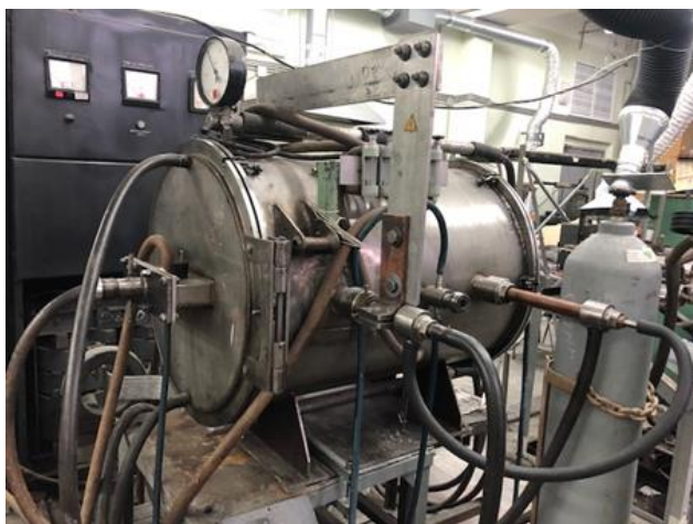
Рисунок 1 – Общий вид модернизированной печи Таммана (а) и цилиндрический графитовый нагреватель (б)
