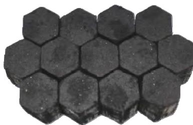
Рис. 1. Образцы формованного монолитного нанопористого активного угля АС-90S
