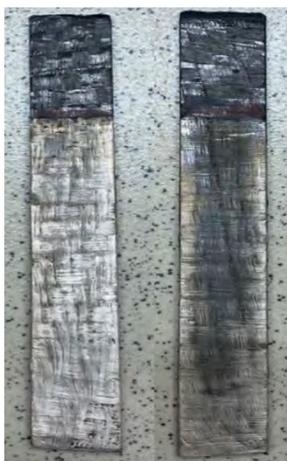
Рисунок 2. Гальваническое покрытие системы медь-никель на образце 2D-УУКМ
