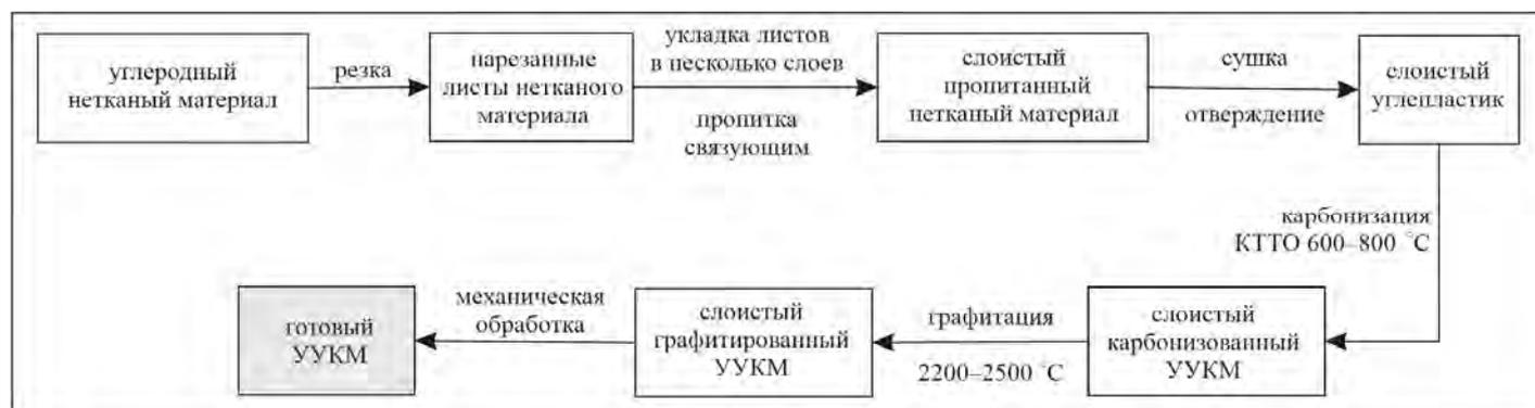
Рис. 1. Схема получения опытных образцов УУКМ
