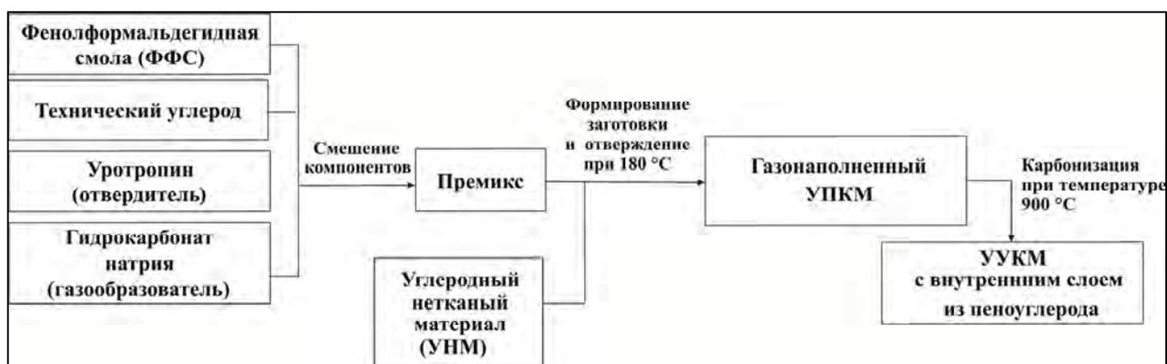
Рис. 2. Схема получения опытных образцов УУКМ с внутренним вспененным слоем
