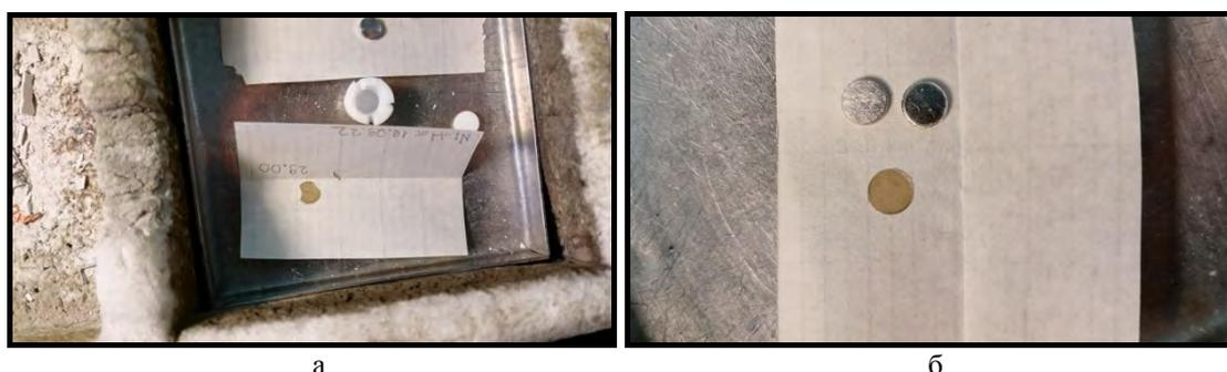
Рис. 1. Плотный образец (#1), синтезированный при давлении 2.8 ГПа и комнатной температуре с выдержкой в течение 18 часов (а); плотный образец (#2), синтезированный при давлении 2.8 ГПа с выдержкой при температуре 150 °С в течение 2 минут, а затем при комнатной температуре в течение суток (б). Снимки образцов сделаны сразу после синтеза.
