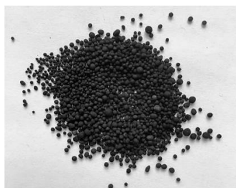
Внешний вид углеродного композита, содержащего фторполимер
