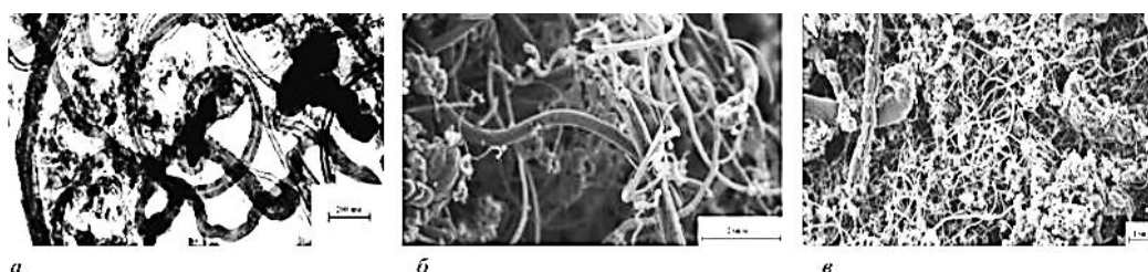
Рис. Фотографии углеродного наноматериала, образующегося на металлической поверхности камеры осаждения - а – полученные посредством ПЭМ; б, в – полученные посредством СЭМ
