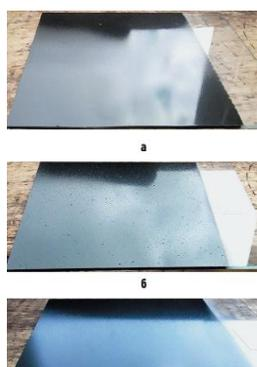
Рассмотрены свойства эмалей различного состава без добавления углеродных нанотрубок и с добавлением. Приведено сравнение значений таких параметров, как блеск, твёрдость, эластичность, коэффициент теплового излучения, коэффициент поглощения солнечной радиации. Показана необходимость дополнительного оснащения рабочих мест при необходимости использования ультразвука для обработки нанотрубок.
