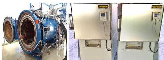
Рис. *Высокотемпературное оборудование для формования полиимидного углепластика*
