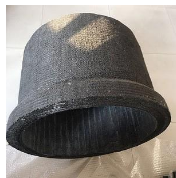
Защита теплоизоляции внутреннего пространства печи углерод-углеродным композиционным материалом
