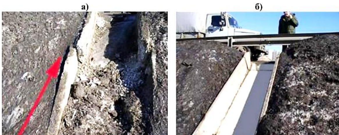
Рисунок 2. Результаты сравнительного испытания водоотводящих лотков 3 : (а) лоток из железобетона; (б) лоток из композиционного материала
