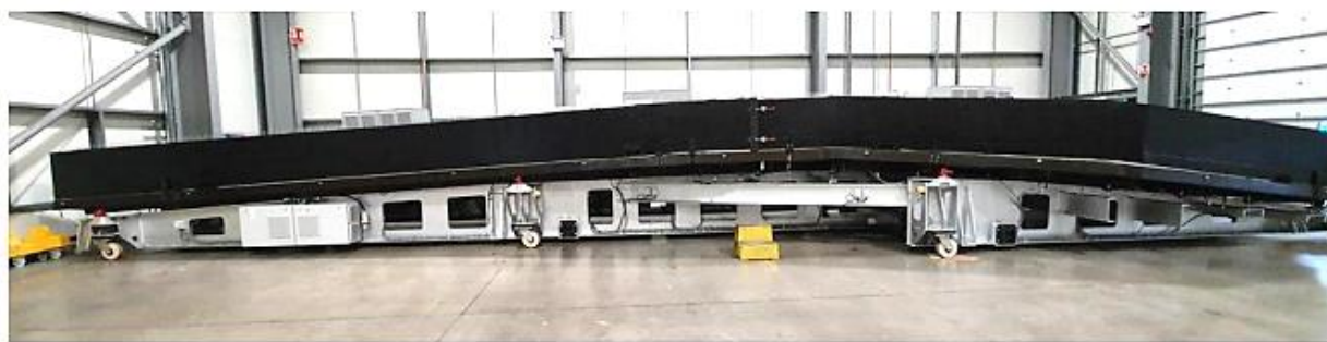
Рис. Оснастка из углепластика для изготовления обшивки крыла с индивидуальной системой нагрева заготовок деталей по зонам
