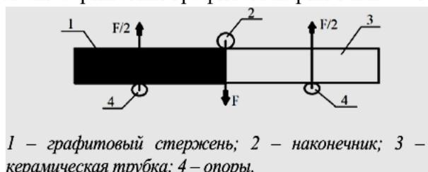
1 – графитовый стержень; 2 – наконечник; 3 – керамическая трубка; 4 – опоры.
