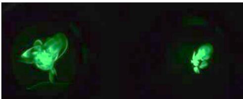
Показано, что для катода на основе УНТ нити при выборе определённых ускоряющих напряжений возможно не только сохранение и стабилизация, но даже улучшение его эмиссионных характеристик. Рис. *Свечение люминофора в системе с катодом из УНТ-нити (слева) и ПАН-волокон (справа).*
