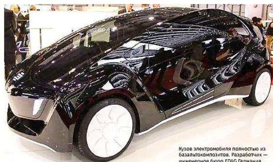
Кузов электромобиля полностью из базальтокомпозитов. Разработчик — инженерное бюро EDAG Германия.
