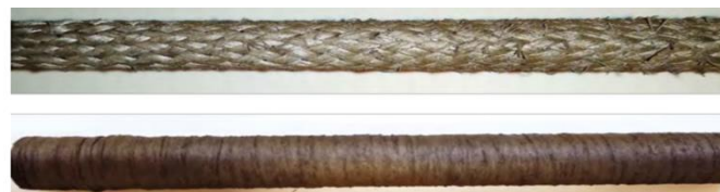
Внешний вид образцов после стадии пропитки волокнистого каркаса из SiC и C газообразным MC и осаждения карбида кремния методом CVI/CVD
