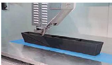
Процесс 3D печати модельной оснастки
