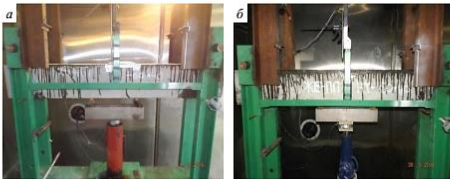
Рис. 2. Испытания основных образцов на одновременное воздействие температуры и внешней длительной статической нагрузки на примере серии «ЖБ-ПП» в интервале температур: а – от –60 до +40 °С; б – от +60 до +110 °С
