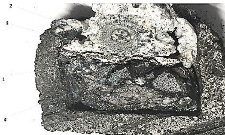
Графитовая фольга (1) в контакте с расплавами алюминия (2) и криолита (3).
