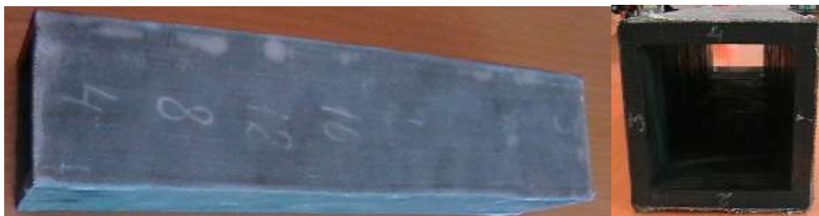
Рисунок 4 – Цилиндр из 32 пластин (8 ячеек) для испытаний на стенде (нумерация пластин от выходного отверстия по часовой стрелке).
