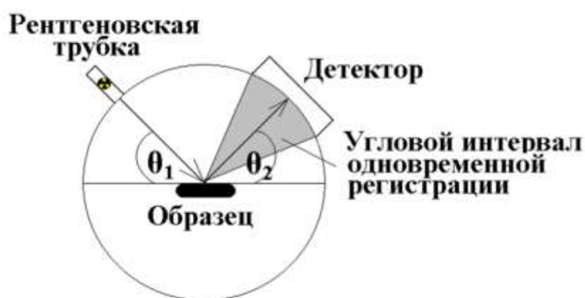
Рисунок 3. Углы установки \theta_1 и детектора \theta_2 по круговой шкале.
