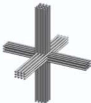
Рисунок 1-Схема армирования 3D УУКМ.
