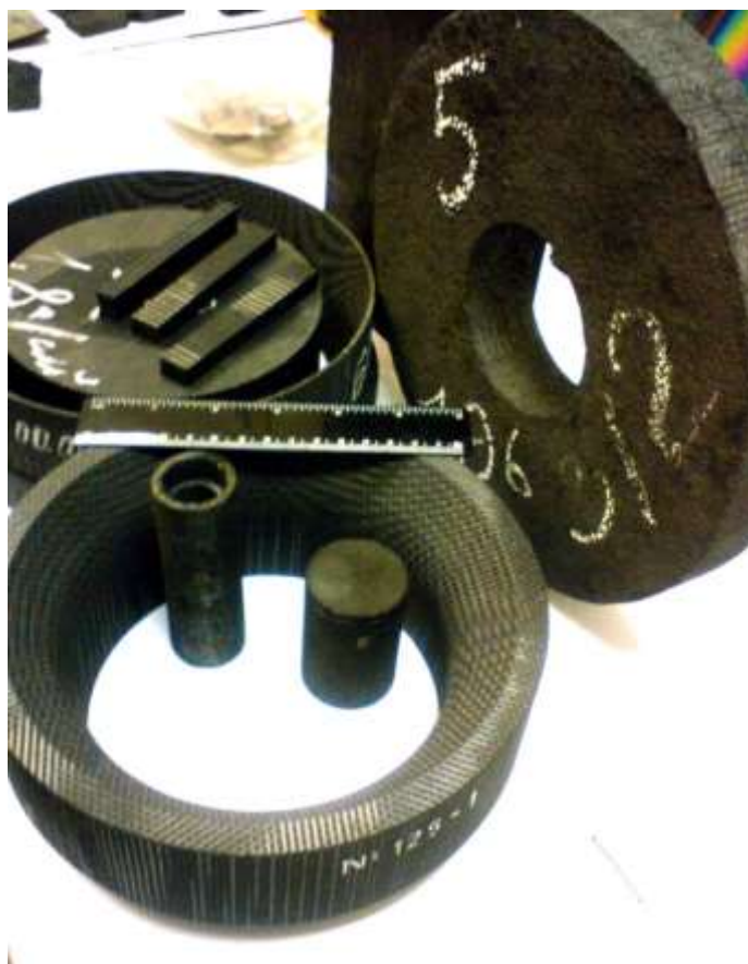
Рисунок 1. Общий вид заготовок и деталей из УУКМ, полученных с применением технологии изостатической карбонизации.
