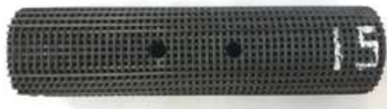
Рисунок 11 – Образец УУКМ, перед определением коэффициента теплопроводности, термообработанный на воздухе с выдержкой при 900°C в течение 3 часов.
