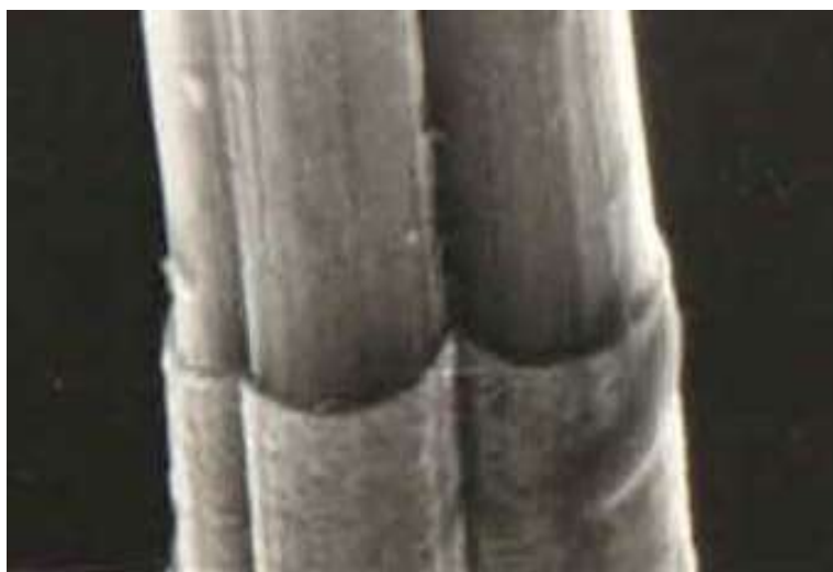
Рис.1.Фотография базальтовых филаментов диаметром 12 мкм (верхняя часть) с нанесенным никель-фосфорным покрытием (нижняя часть). Увеличение x5000.
