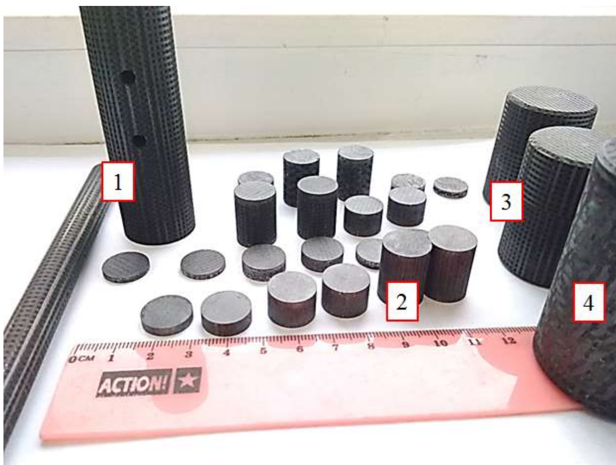
Рисунок 5. Внешний вид образцов для исследования теплофизических свойств. 1 – определение теплопроводности при повышенных температурах; 2 – определение теплопроводности образцов различной толщины; 3 - образцы изделий 3-х мерного и 4 – двумерного армирования.
