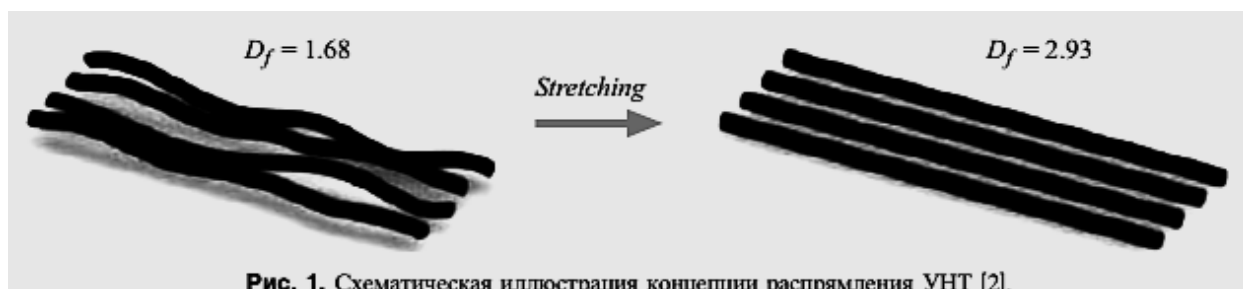
Рис. 1. Схематическая иллюстрация концепции распрямления УНТ [2].
