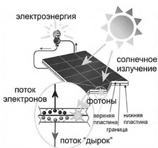
Рис. 1. Принцип работы солнечной батареи
