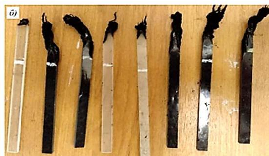
Внешний вид образцов в исходном состоянии (а) и после испытаний в условиях кислородного индекса (б)
