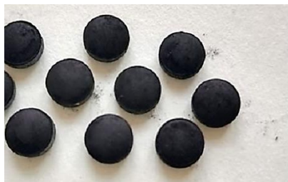
Компактированная форма композита ПАНИ/МПУ
