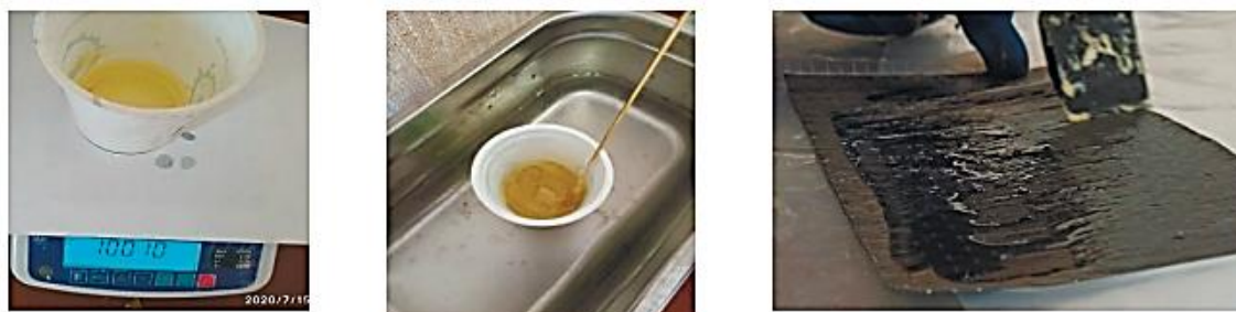
Рис. 1. Подготовка полимерного связующего, добавление нанопорошков
