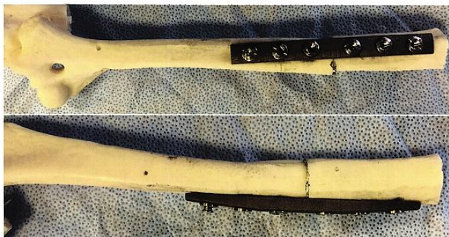
Рис. Общий вид пластины с заклепками после остеосинтеза перелома кости
