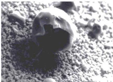
подложку при постоянном токе в реакционной вакуумной камере, при этом на термостойкую подложку, выдерживающую температуру до 500°C, распылением мишени, состоящей из углерода и алюминия при отношении их площадей, занимаемых в мишени, равном 8:1, наносят пленку толщиной от 1 до 7 мкм, после чего выдерживают подложку с пленкой в реакционной вакуумной камере не менее 5 мин, с образованием на поверхности пленки квантовых точек диаметром от 10 до 150 нм с внутренними полостями и стенками из графена с
