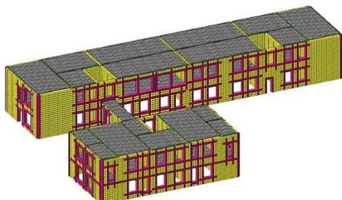
В статье рассмотрен метод усиления кирпичного здания углепластиковыми материалами. Показана эффективность данного усиления по сравнению с традиционными методами усиления кирпичных зданий. Расчет здания без усиления и с усилением позволил определить эффективность усиления углеродными лентами. Для экономического сравнения вариантов усиления использовался базисно-индексный метод. Усиление углепластиковыми материалами дешевле
