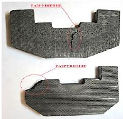
Рис. Разрушенное испытательное приспособление.
