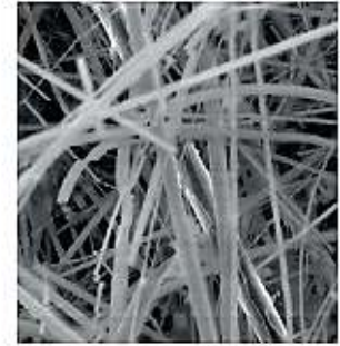
Рис. 2. Микроструктура ТИМ из коротких базальтовых волокон со связкой Al_2O_3 .
