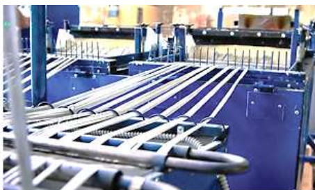
Рис. Механизм для производства базальт-стеклопластиковой арматуры.
