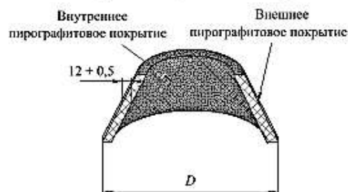
Рис. 2. Конфигурация деталей различного диаметра D при одинаковой толщине стенки (12 мм), изготовленных из армированного пирографита.
