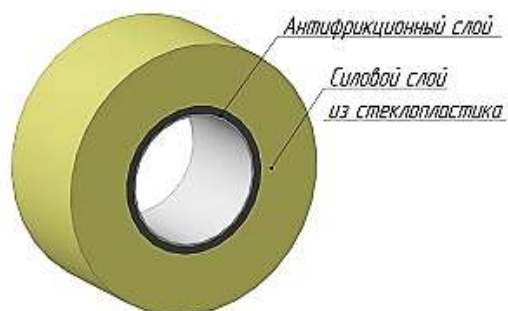
Рисунок 2 – Общий вид подшипника скольжения из композиционно-волокнистых материалов
