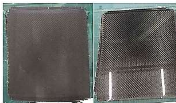
Рисунок 7. Образец углепластика, полученного методом вакуумной инфузии.
